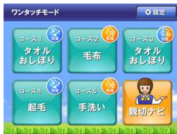
図2 タッチパネル画面 (ワンタッチモード、コース選択画面)
