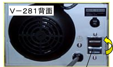
主電源スイッチ
