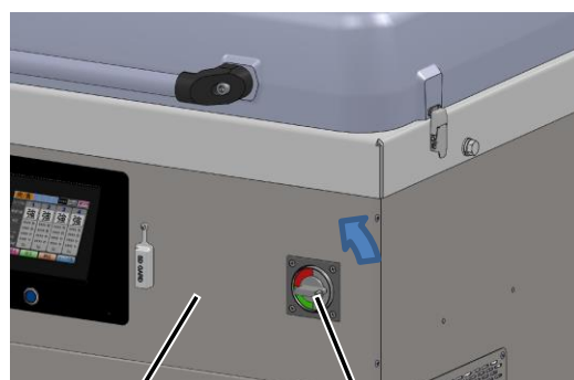
コントロールパネル 主電源スイッチ
