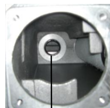
ポンプ内に張り付いたOリング
