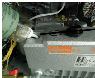
オイル量を確認しながら給油
