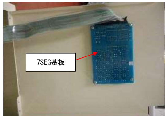
[操作パネル 裏側(7SEG基板)]
