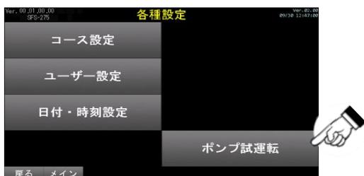
④ ポンプ試運転画面で各ポンプの『ON』をタッチするとポンプが動作し、『OFF』をタッチするとポンプが停止します。
