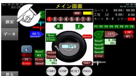
③ 各種設定画面で『ポンプ試運転』をタッチしてポンプ試運転に移行します。
