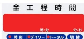
切替スイッチを押すと全工程時間から時刻表示に切替わります。
