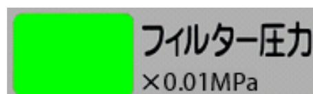
○ ポンプ運転中は表示部にフィルター圧力を表示します。
