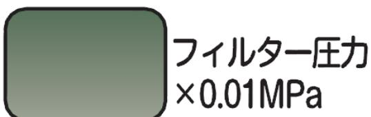
ポンプ運転中は表示部にフィルタ圧力を表示します。
