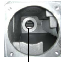
ポンプ内に張り付いたOリング
