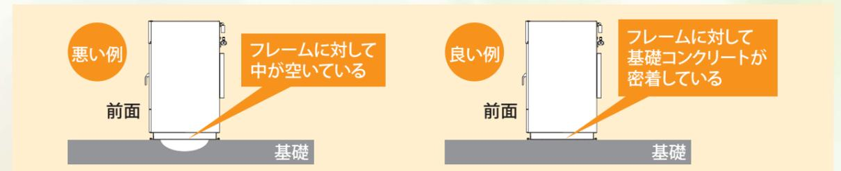
\*基礎コンクリートに対して、中空部(排水口、溝など)によってベッドが完全に密着していない場合、振動の原因になるケースがあります。
